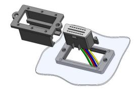
Halterahmen auf die Rückseite der ausgesparten Verkleidung legen und Buchse durchführen. Schieben Sie die OBD-Buchse in das OBD-Saver Gehäuse.
